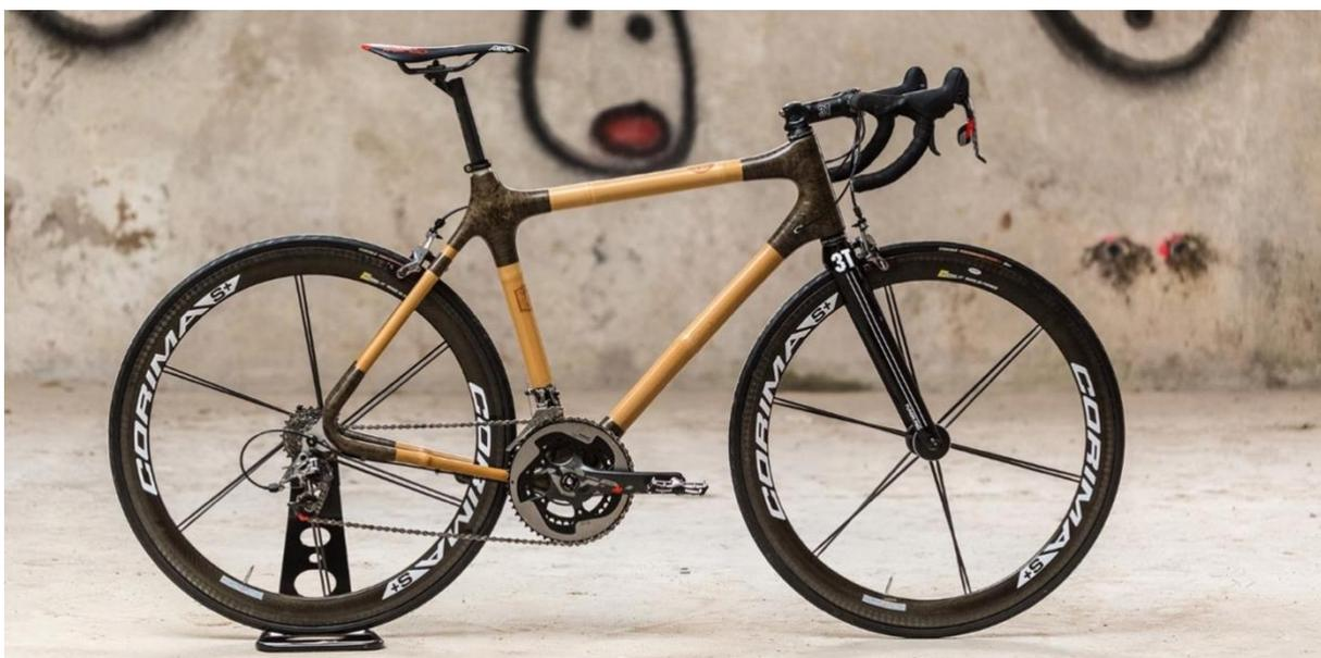
Photo 3 : Vélo In'Bô en bambou réalisé sur-mesure par leurs artisans
